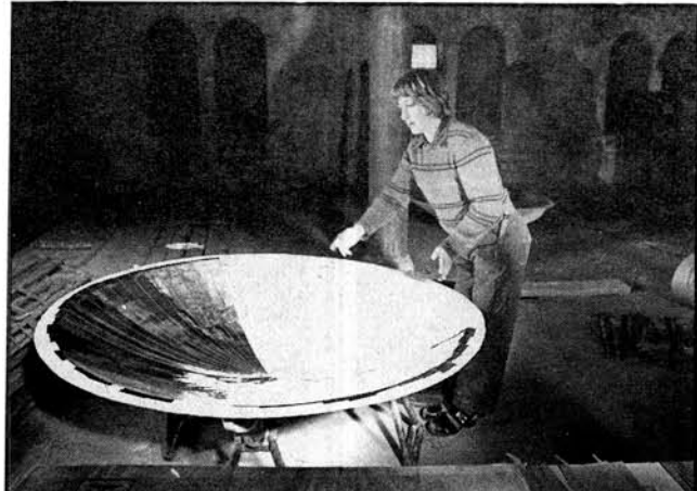
● I toppen av tältet skall man ha två stora ljusreflektorer. Här limmar Maria Grahm aluminiumplast i den stora formen. Maria har förresten en av de viktigaste uppgifterna under turnén. Hon är skyddsombud, och efter specialutbildning skall hon kolla arbetsmiljön före alla spelningar.
